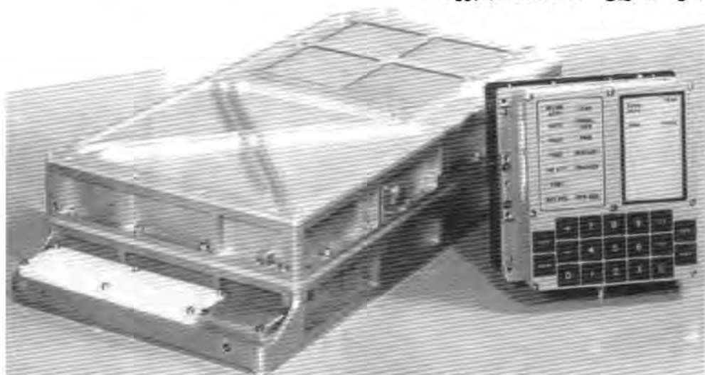
يەكەى ناسراۋ بە (كۆمپيوتەرىى ناراستەكارىى ئەپۇلۇ) واتە ( Apollo Guidance Computer) بان (AGC)
